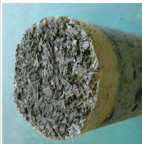
写真. 5. 3 34年経過した木毛セメント板打込み面の中性化深さの例
